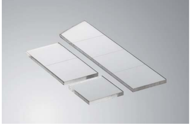
对 500 \mu\text{m} 厚的 4H-SiC 晶圆进行单向 (300 mm/s) 切割。
