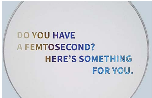
形状诱导双折射延迟的变化导致在平行偏振光中显示不同的颜色。 样品源自: Workshop of Photonics。
