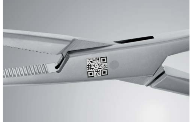
使用Biburst功能在不锈钢止血钳上进行无腐蚀的黑白打标。
