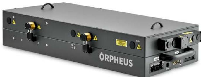
ORPHEUS-TWINS 由两个独立可调的光参量放大器 (OPA) 组成, 结构紧凑。OPA 是光学同步的, 并且提供同时输出。两个 OPA 集成一体, 共享相同的白光种子光, 从而能够产生具有被动载波包络相位 (CEP) 稳定性的宽带宽中红外输出。
