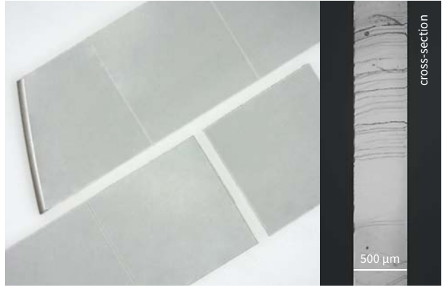
对 500 μm 厚的 4H-SiC 晶圆进行单向 (300 mm/s) 切割。
