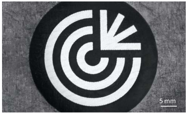
在不锈钢夹子上使用 BiBurst 加工的高对比度黑白标记。
