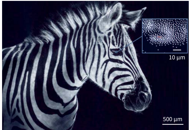
使用选择性激光烧蚀技术去除了蓝宝石衬底上 10 nm 厚的陶瓷层。
